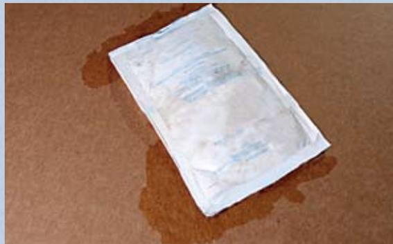
Quando o dessecante é mais necessário - em altos níveis de umidade - as bolsinhas se tornam super saturadas e param de absorver. Uma vez super saturadas, normalmente também ocorre vazamento.
