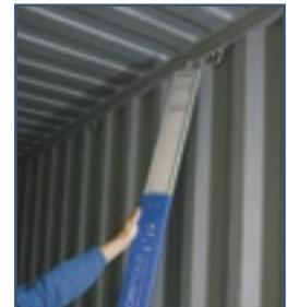
**7** O ABSORPOLE® agora está pronto para ser usado pendurando -o nas alças acima das partes corrugadas no painel da parede do contêiner.
