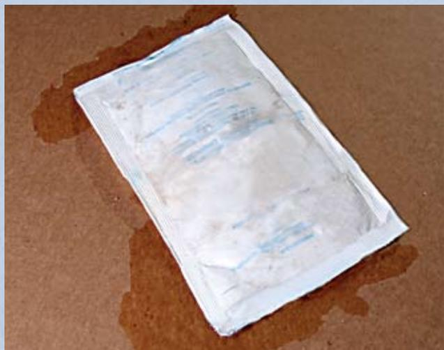
Quando o dessecador é mais necessário—em altos níveis de umidade—o tipo de bolsinha se torna super saturada e para de absorver. Uma vez super saturadas, normalmente também ocorre vazamento.
