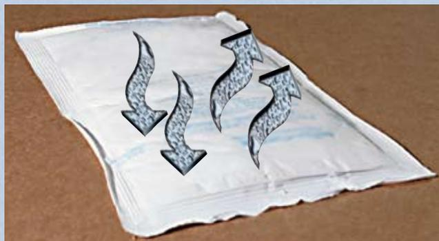
Devido ao projeto dos dessecadores do tipo bolsinha, eles sempre liberam a umidade absorvida de volta para o interior do contêiner em um ciclo diário.
