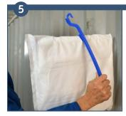
Sujete la barra con gancho por la punta inferior y levante hacia el anillo del contendor.
