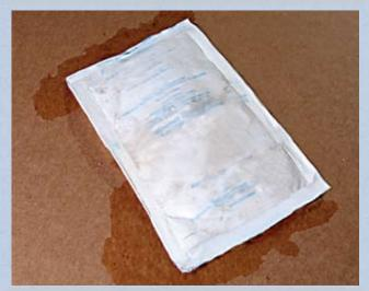
Cuando más se necesita el desecante a altos niveles de humedad, el desecante tipo bolsa se sobresatura con facilidad y deja de absorber. Una vez que se sobresatura, habitualmente también se produce filtración.
